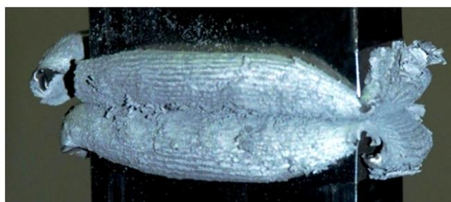
Figura 8: Aspetto del giunto ottenuto per LFW su AMC225xe.
