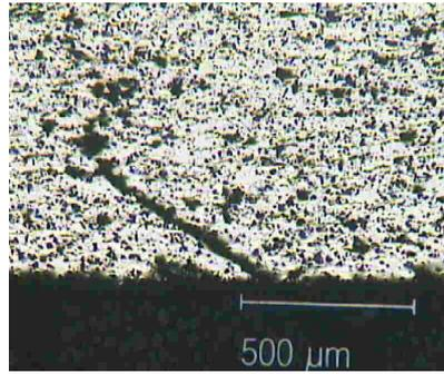
Figura 4: Difetto dovuto alla non completa penetrazione di saldatura sul lato opposto alla spalla dell'utensile nel giunto FSW sul composito W7A10A.
