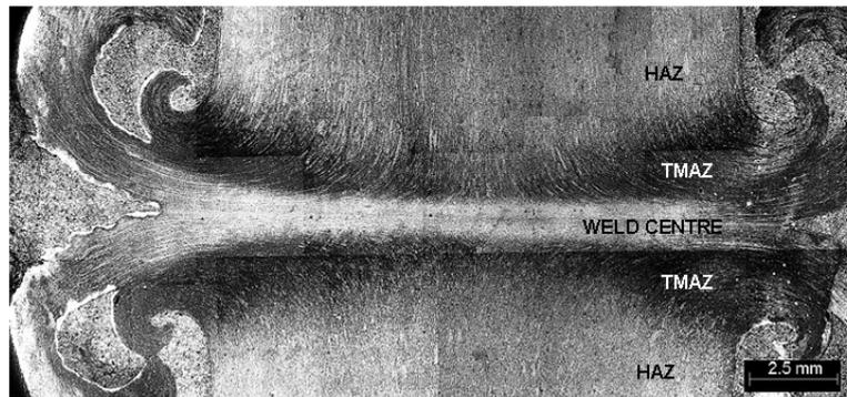
Figura 9: Micrografia a basso ingrandimento del cordone di saldatura LFW per AMC225xe.
