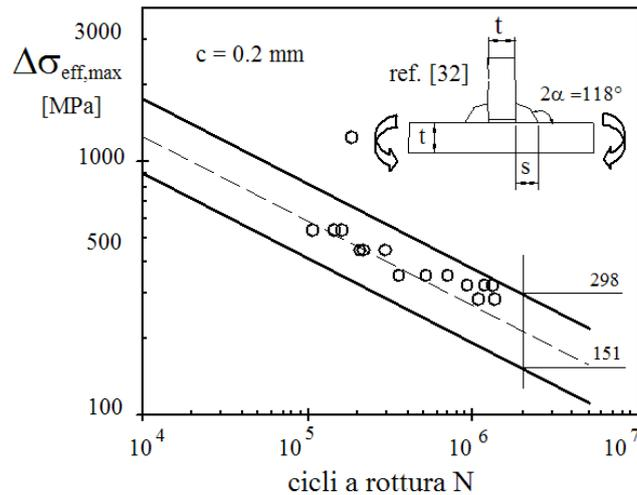
Figura 6: Previsione della resistenza a fatica calcolata per via completamente numerica di una saldatura a T avente angolo di apertura di  $118^\circ$  sollecitata a flessione ( $t=10$  mm,  $s=7.8$  mm,  $R=0.1$ ).
