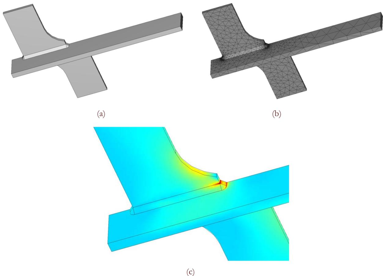
Figura 3: Esempio di mesh e soluzione ottenuto in automatico partendo dal modello CAD di un giunto complesso:
