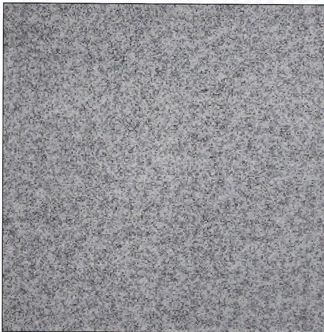
Figura 1: microstruttura delle barre Ø 285, d'acciaio LOS 2344, allo stato ricotto. Perlite globulare omogenea. Zona 1/2 raggio. Attacco nital 2% - 500 x.
