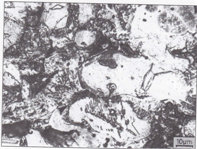
Fig. 5 - Campione 6 al centro: austenite in via di trasformazione, bainite con varie morfologie, perlite finissima
