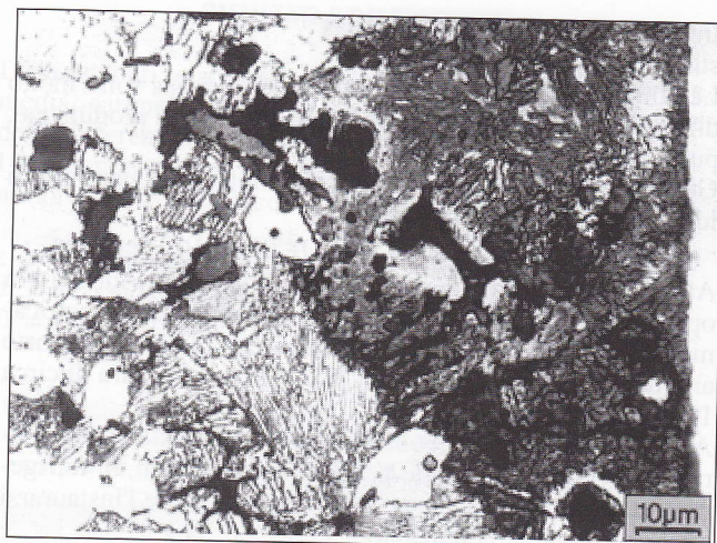
Fig. 8 - Campione 4 al bordo: evidente nella zona più esterna presenza di martensite
