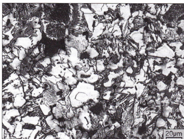
Fig. 12 - Campione 10: bainite, austenite in via di trasformazione, austenite residua, tracce di perlite finissima.
