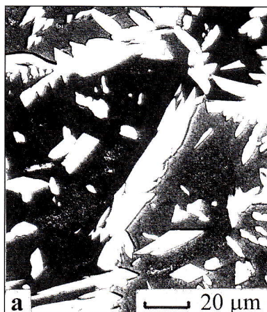
Fig. 8 - TIG welded microstructures 8a - melted zone (Beraha) 8b - HAZ (oxalic).
