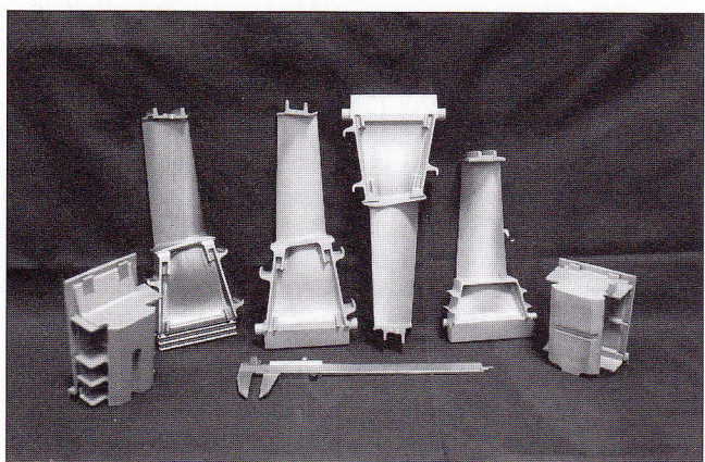
Fig. 2 e 3 - Alcune applicazioni dell'Inconel 738 (scudi termici, palette, rotori per turbine a gas).
