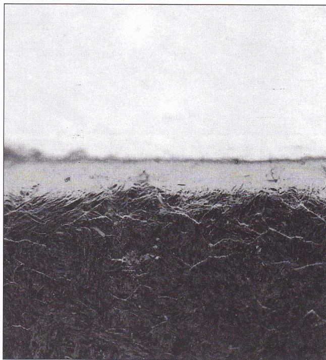
Fig. 4 - 41CrAlMo7 steel after Basonit process (500X). Fig. 4 - Acciaio 41CrAlMo7 dopo processo Basonit (500X)
