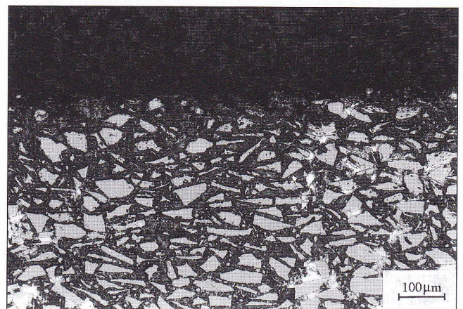
Fig. 5 - Danneggiamento subsuperficiale nel campione 65SI usurato a 200 N.
