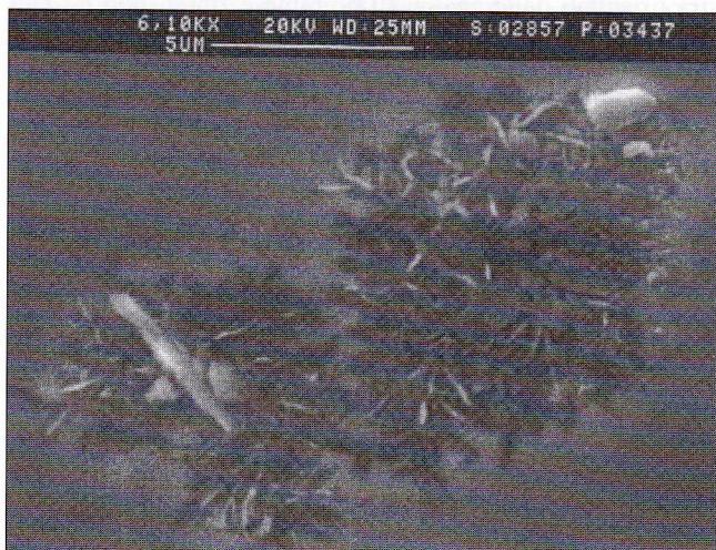
Fig. 2f - Lega B: micrografia elettronica (SEM-SE) della superficie nello stato rifuso dopo curva potenziodinamica in saliva artificiale.
