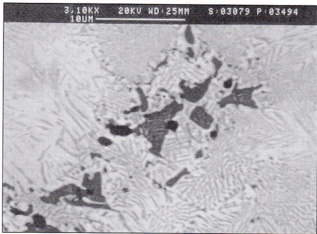
Fig. 2d - Lega C: micrografia elettronica (SEM-BSE) nello stato rifuso senza attacco metallografico.
