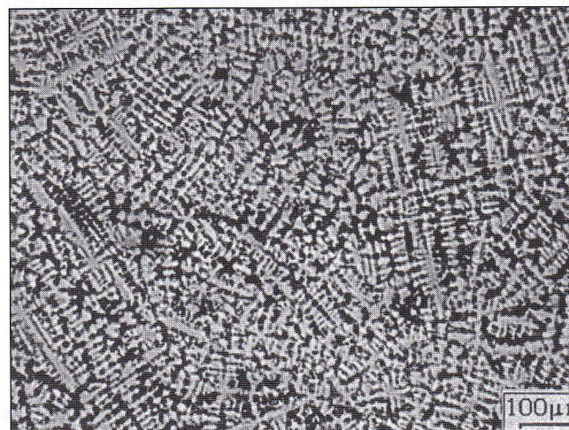
Fig. 2b - Lega B: micrografia ottica nello stato greggio di fusione dopo attacco elettrolitico con il reattivo di Jacquet.
