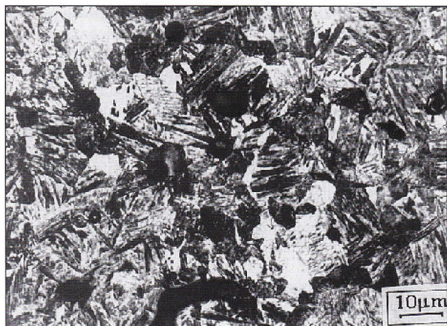
Fig.11: Microstruttura del materiale S16: sono visibili martensite, prevalente, e austenite in via di trasformazione.
