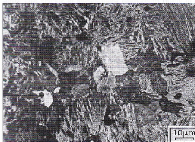
Fig.12: Microstruttura del materiale 1250: martensite, perlite finissima, isole di austenite in via di trasformazione.
