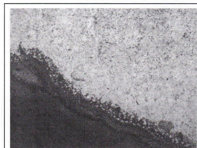
Vernice 48h - 200X Il fronte corrosivo procede in modo quasi planare: si notano frammenti di acciaio nell'alluminio del bagno.
