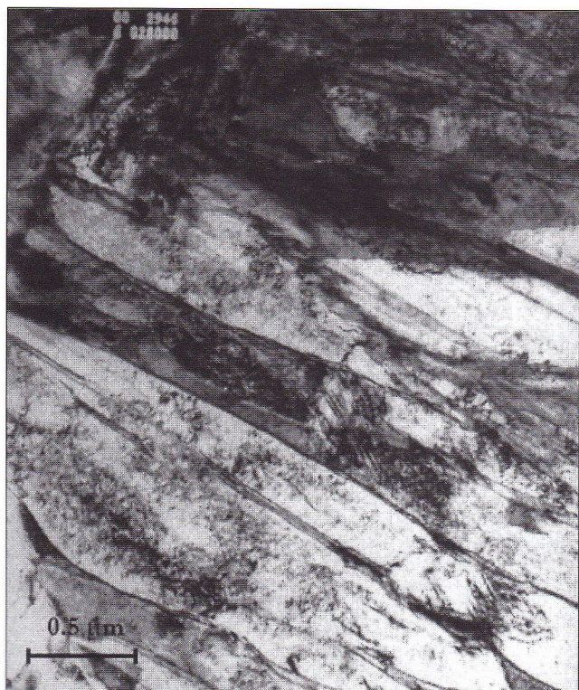
Fig. 1: microstruttura dell'acciaio dopo tempra (Q). Fig. 1: steel microstructure after quenching (Q).
