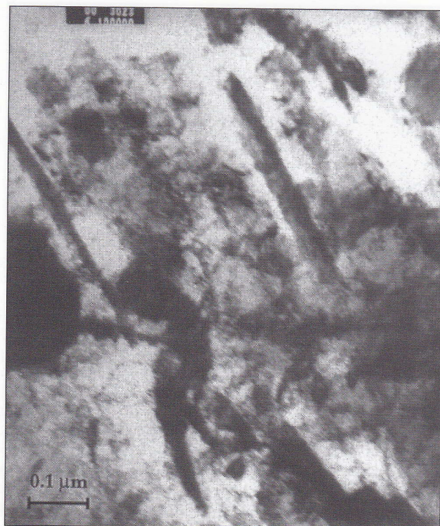
Fig. 7: particolare in campo chiaro (BF) del materiale dopo bonifica (Q+C+2T): cementite a bordoplacca.
