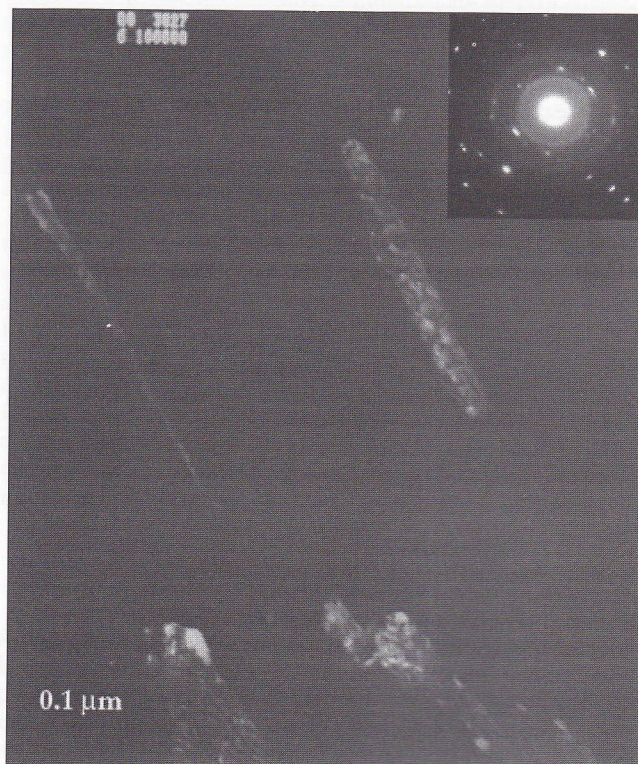
Fig. 8: campo scuro (DF) della micrografia di fig. 7 ottenuto orientando il campione lungo il piano di diffrazione della cementite.
