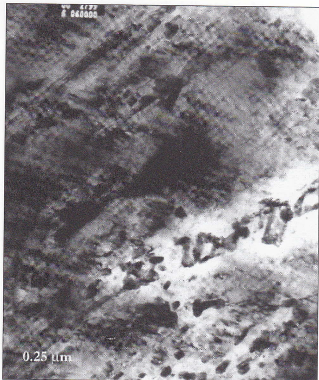
Fig. 5: microstruttura dell'acciaio dopo tempra e doppio rinvenimento (Q+2T).
