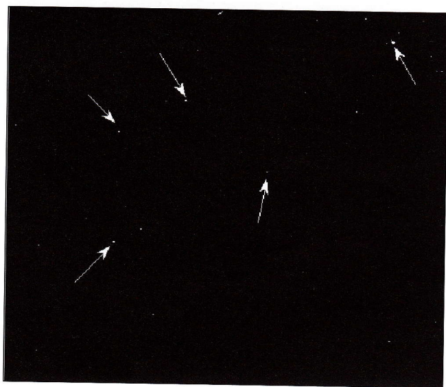
Fig. 12 Micrografia elettronica TEM in campo scuro ottenuta selezionando le riflessioni attese da carbonitruri coerenti con la matrice ferritica.
