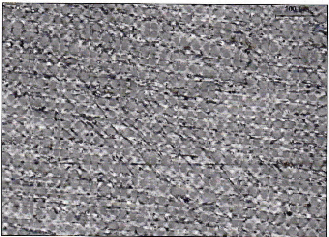
Fig. 11: Campione longitudinale deformato al 50%+TT700_20+50%. (100X)
