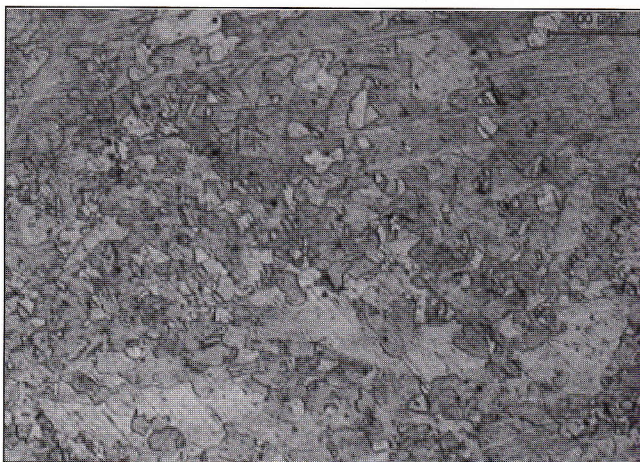
Fig. 13: Campione longitudinale deformato al 50%+TT750_20. (100X)
