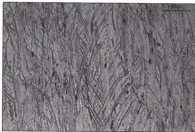
Fig. 16: Campione longitudinale deformato al 50%+TT750_20+60%. (200X)
