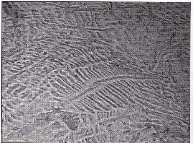
Fig. 3: Deformazione della struttura dendritica in campione laminato al 50%. (200X)
