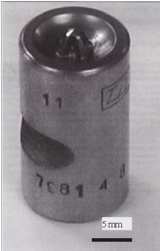
Fig 3: Recess tool realizzato con AISI M2 nanostrutturato
