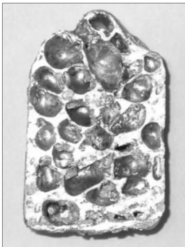
Fig. 7 – Schiuma di Al prodotta senza particelle di SiC nella miscela di partenza.
