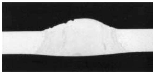
Fig. 1 – Lega di alluminio 5056 saldata TIG: porosità superficiale. Fig. 1 – 5056: surface porosity of a TIG weld.
