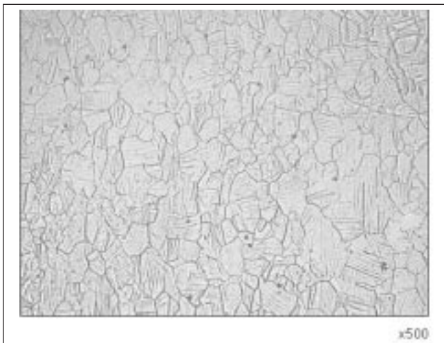
Fig. 10 – Materiale base tubo x500. Attacco: HCL+HNO 3 .
