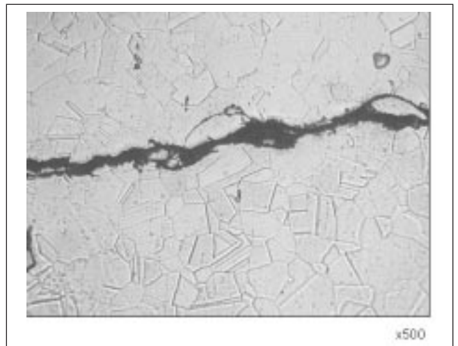
Fig. 9 – Andamento della cricca nella zona termicamente alterata lato tubo x500.
