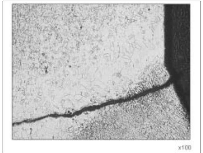
Fig. 7 – Innesco della cricca di Fig. 6 x100. Attacco: HCL+HNO 3 .
