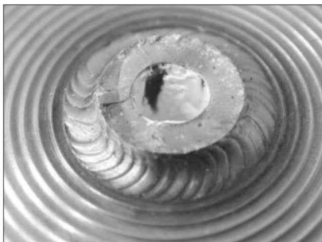
Fig. 2 – Particolare del camp. A . Superficie della frattura lato flangia.
