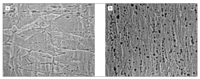
Fig. 11 – Microstruttura di una lamina di spessore 1.5 mm: sezione longitudinale (a) e trasversale (b).
