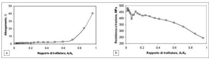
Fig. 6 - Variazione dell'allungamento (a) e della resistenza alla trazione (b) per effetto della trafilatura.
