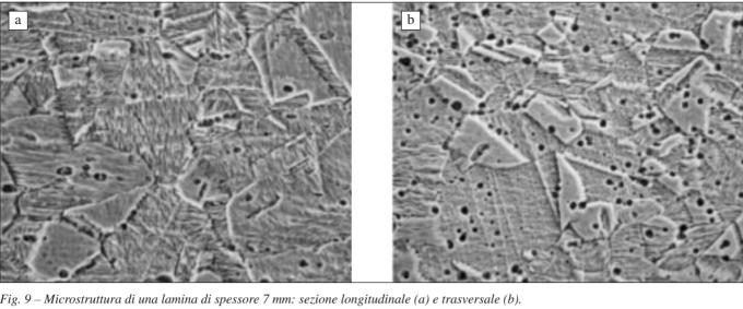
Fig. 9 – Microstruttura di una lamina di spessore 7 mm: sezione longitudinale (a) e trasversale (b).
