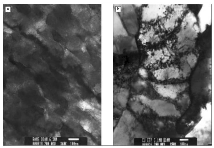
Fig. 2 – Microstrutture della sezione trasversale del filo di Ø 6.6 mm (a) e del filo di Ø 3.2 (b): il groviglio di dislocazioni si infittisce ed i precipitati ai bordi di grano aumentano con il procedere della trafilatura.
