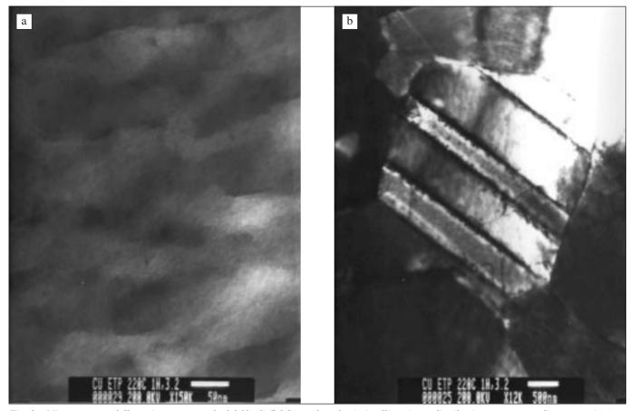
Fig. 3 – Microstruttura della sezione trasversale del filo di  $\emptyset$  3.2 mm dopo la ricristallizzazione: distribuzione omogenea di sottograni (a) e geminati (b).
