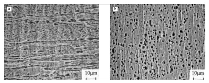
Fig. 13 – Microstruttura di una lamina di spessore 0.5 mm: sezione longitudinale (a) e trasversale (b).
