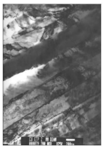
Fig. 1 – Microstruttura della sezione longitudinale del filo di  $\emptyset$  2 mm: grani allungati nella direzione della trafilatura.
