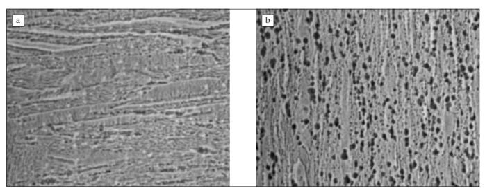
Fig. 12 – Microstruttura di una lamina di spessore 1 mm: sezione longitudinale (a) e trasversale (b).
