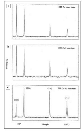
Fig. 14 – Attivazione di diversi piani di scorrimento durante la laminazione: diffrattogrammi delle lamine di spessore 3 mm (a), 2 mm(b) e 0.5 mm(c).
