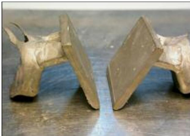
**FIG. 1** *Provini in titanio (Ti - CP grado 2) prodotti mediante fusione a cera persa.*
