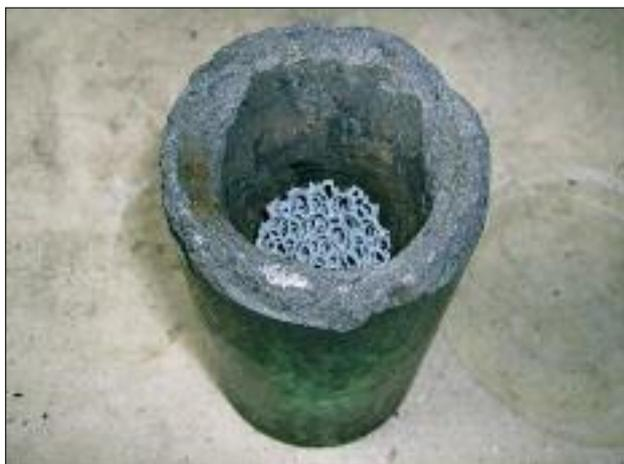
**FIG. 3** *Alloggiamento del filtro ceramico nella lingottiera di grafite.*
