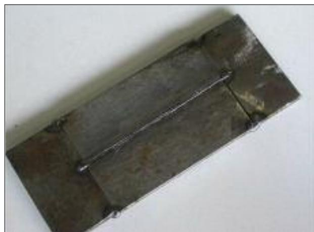
FIG. 9 Giunto saldato con evidenza dei punti di saldatura effettuati per il bloccaggio iniziale delle lamiere posizionate di testa.
