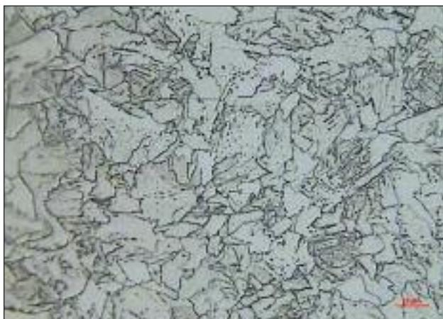
**FIG. 1** Lamiera A: metallo base in acciaio ferritico S235JRG2-EN 10025/94, attaccato con soluzione Nital (2% HNO<sub>3</sub>, 98% alcol etilico).
