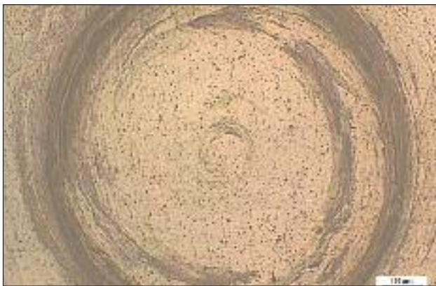
**FIG. 4** Centro del retro della saldatura.
