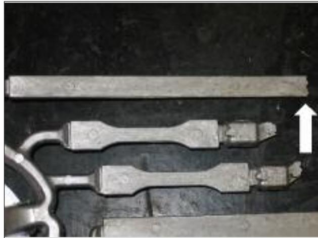
**FIG. 5** Esempio di getto incompleto nella zona dell'appendice di fluidità. La freccia indica la zona critica con spessore di 1 mm.
