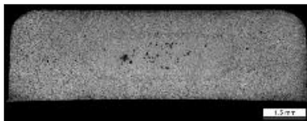
**FIG. 13** **Sezione trasversale di una provetta per prove di trazione in lega EN AC 46000 dopo attacco metallografico. Le zone più scure nelle macrografie contengono una frazione eutettica più elevata.**
