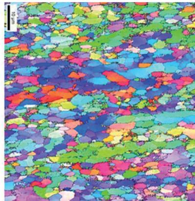
**Fig. 12 - Microstruttura relative al Trial 1 (a: analisi TEM in sezione sottile: b) analisi EBSD)**
