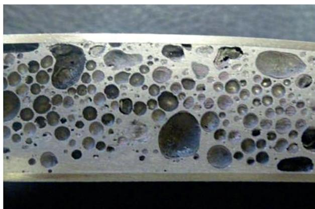
**Fig. 7: Sezione del pannello ottenuto con schiumatura del precursore composito mostrato in Fig. 6 a).**
