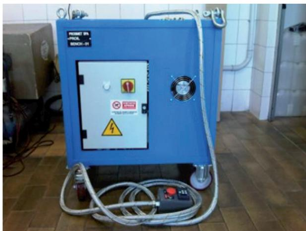
**Fig. 7 - Carrello con sistema di pompaggio.**
