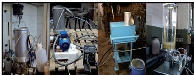
**Fig. 6 - Modelli alfa, beta, gamma e delta delle pompe dosatrici a pistoni.**
