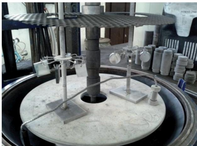
**Fig. 2 - Interno del forno di nitrurazione**
