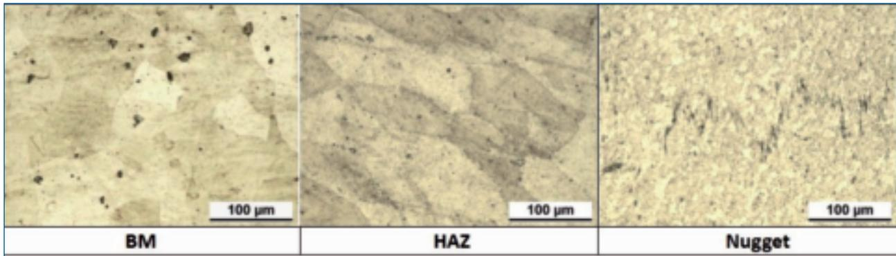
**Fig. 1 – Microstruttura della lega saldata AA2139.**
