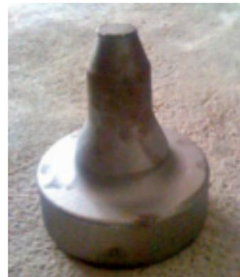
**Fig. 4 - Campione 1 usato per le prove sperimentali: altezza 380 mm, diametro 250 mm**
