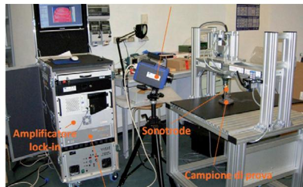
**Fig. 8 - Set up sperimentale utilizzato in laboratorio per le misure termografiche (termografia lock-in con eccitazione ad ultrasuoni).**
