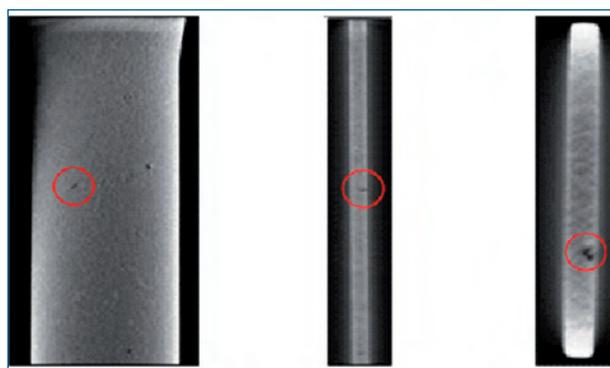
**Fig. 15 - Individuazione del difetto in un provino in ghisa attraverso sezioni tomografiche effettuate su tre diverse viste.**
