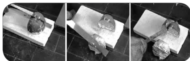
Fig. 13 Sequenza del "taglio" della lega ottenuta con proprietà tixotropiche. Tixotropic behaviour of the treated alloy.
