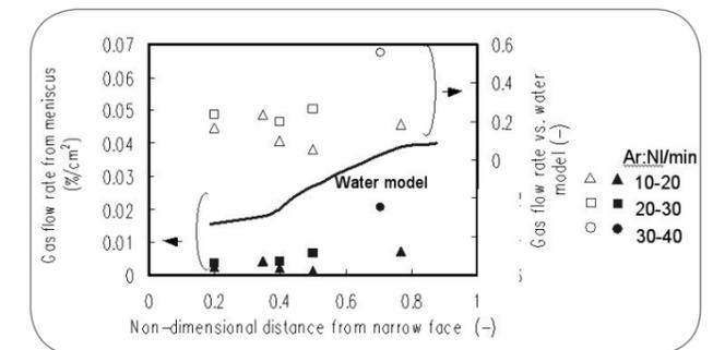
Fig. 3 Distribution of gas extraction in commercial slab caster comparing with water model. Distribuzione dell'estrazione di gas in un commercial slab caster a confronto con il modello di flusso con acqua.
