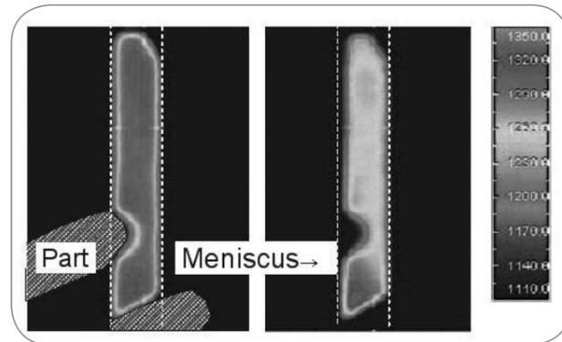
**Fig. 5** In-situ observed molten steel flow in the nozzle by thermography. a) Ar: 1NI/min; b) Ar: 5NI/min. Flusso dell'acciaio liquido nell'ugello osservato in situ mediante termografia. a) Ar: 1NI/min; b) Ar: 5NI/min.
