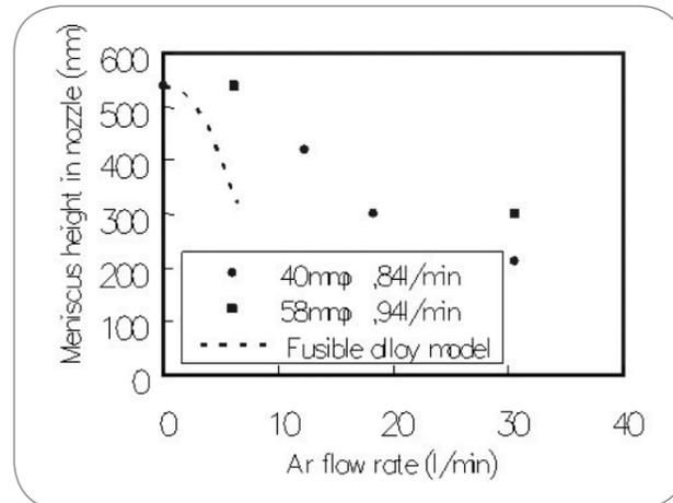
**Fig. 6** Meniscus heights measured by molten steel model comparing with fusible alloy model result. Altezza del menisco misurata nel caso del modello con acciaio liquido confrontato con i risultati del modello con lega fusibile.
