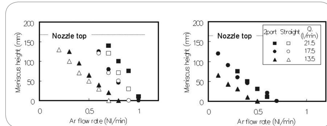
Fig. 4 Meniscus height inside nozzle measured by fusible alloy model. a) 30mm dia.; b) 40mm dia.. Altezza del menisco all'interno dell'ugello misurato nel caso di modello con lega fusibile; a) 30mm; b) 40mm.
