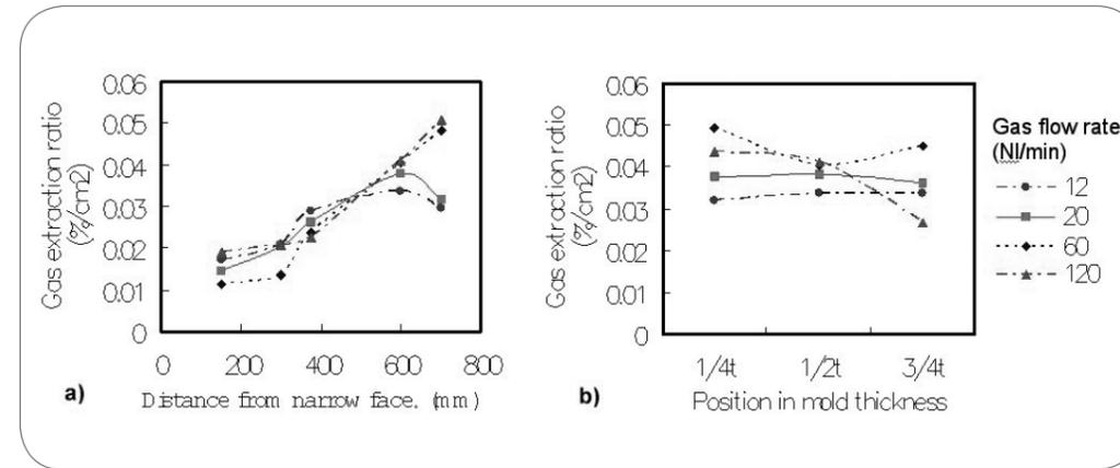
Fig. 2 Distribution of gas extraction from mold meniscus. a) Mold width direction; b) Mold thickness direction. Distribuzione dell'estrazione di gas dal menisco. a) in direzione della larghezza dello stampo, b) in direzione dello spessore dello stampo.
