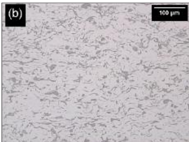
FIG. 2 (b) Micrografie di rivestimenti ottenuti con tecnica APS a base CoNiCrAlY con: a) polveri di allumina grossa (serie 1), b) polveri di allumina a grana fine (serie 2), c) polveri di allumina a grana grossa sferoidale (serie 3).
