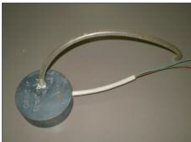
FIG. 5 Tubicino per la misura di potenziale.
