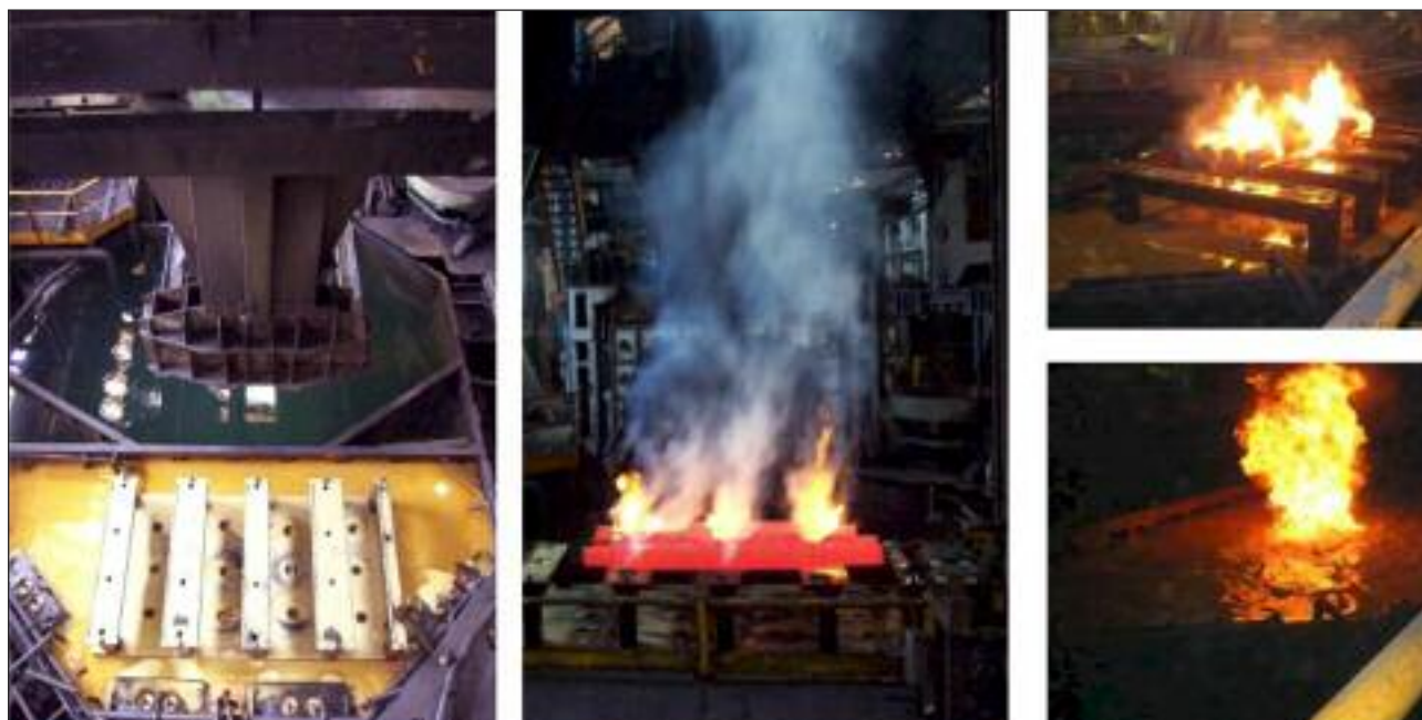
FIG. 3 Vecchia fase di spegnimento in olio di assili ferroviari.
