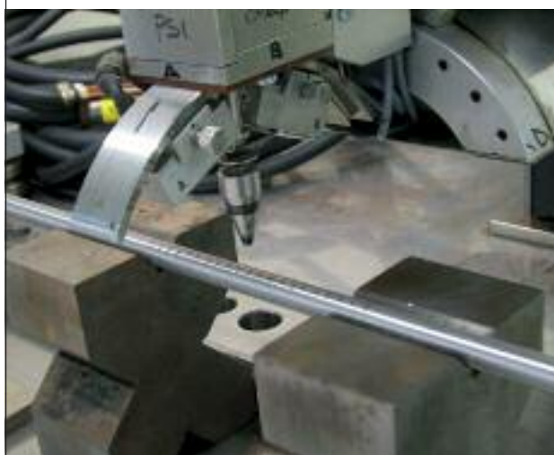
FIG. 7-8 Diffratometro XRD utilizzato per le misure presso Peen Service.
