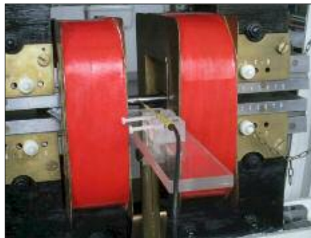
FIG. 2 Permeametro utilizzato per la magnetizzazione dei campioni presso I.N.R.I.M.
