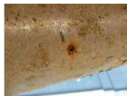
FIG. 6 Aspetto di un cratere su un asse portaelica. View of a crater on a propeller shaft.
