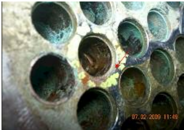
FIG. 15 Aspetto del foro localizzato su tubo appartenente a un secondo scambiatore. Anche questo foro giace presso la piastra tubiera, in una zona caratterizzata da notevole diminuzione di spessore a geometria ben definita, di goccia inclinata nella direzione del flusso.
