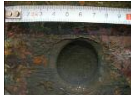
FIG. 10 Cratere dopo asportazione della pittura. Crater after painting removal.
