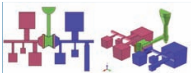
Fig. 1 - Schema dell'attrezzatura sperimentale di colata
