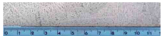
Fig. 3 - Macrografia a cuore lingotto 26NiCrMoV11.5
