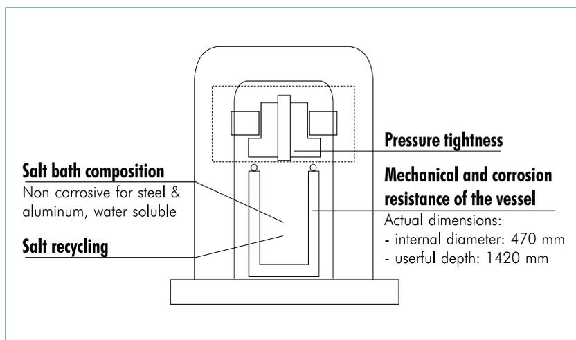
Fig. 2 : LHIP schematic concept
